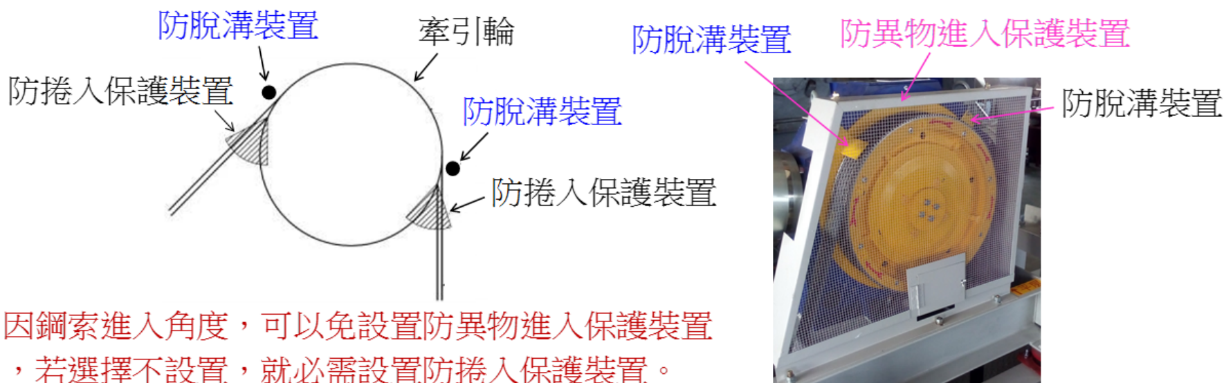
圖 18 有機房電梯之牽引輪防護例
